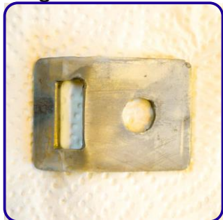
Nach dem Verzinken, leichter Gelbstich erkennbar
